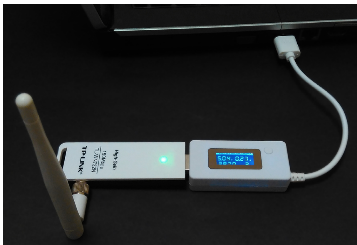
TL-WN722N потребляет 1360 мВт в режиме мониторинга
